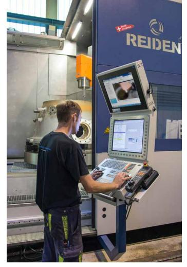
Investimento sicuro: Grimsel Hydro si occupa dell'ammodernamento di centrali idroelettriche. Con il nuovo centro di lavoro a 5 assi REIDEN RX 18 e il controllo numerico HEIDENHAINTNC 640 è perfettamente equipaggiata per il futuro.
