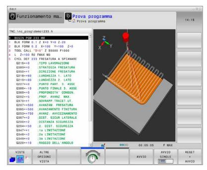
Esempio: lavorazione a righe di una superficie piana con due limitazioni e raggio dell'angolo.
