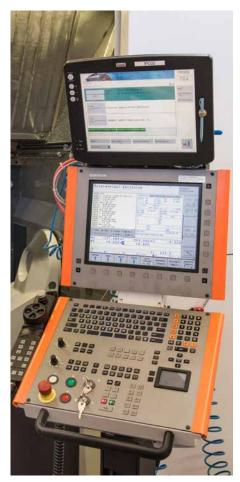
iTNC 530 e Shop Floor Management sono collegati direttamente tra loro per il rilevamento automatico dei dati macchina.
