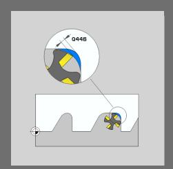
Q446 – Materiale residuo: spessore del materiale residuo a partire dal quale il TNC non deve più lavorare il profilo. Valore standard 0,01 mm.
