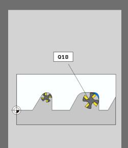
Il ciclo 25 PROFILO SAGOMATO lavora, insieme al ciclo 14 PROFILO, profili aperti e chiusi. Con il nuovo rilevamento del materiale residuo, il ciclo fresa ora in maniera ancora più intelligente: la fresa lavora soltanto gli spigoli e i raggi che l'utensile di sgrossatura non è stato in grado di raggiungere – senza percorrere il profilo completo.
