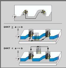
Q447 – Distanza di collegamento: distanza massima tra due aree da svuotare tra cui l'utensile deve traslare lungo il profilo senza movimento di sollevamento alla profondità di lavorazione.
