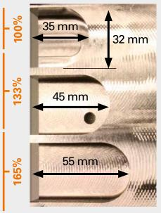
Tecnologie di fresatura a confronto: tradizionale (in alto), fresatura trocoidale (al centro) e fresatura trocoidale in combinazione con AFC (in basso).
