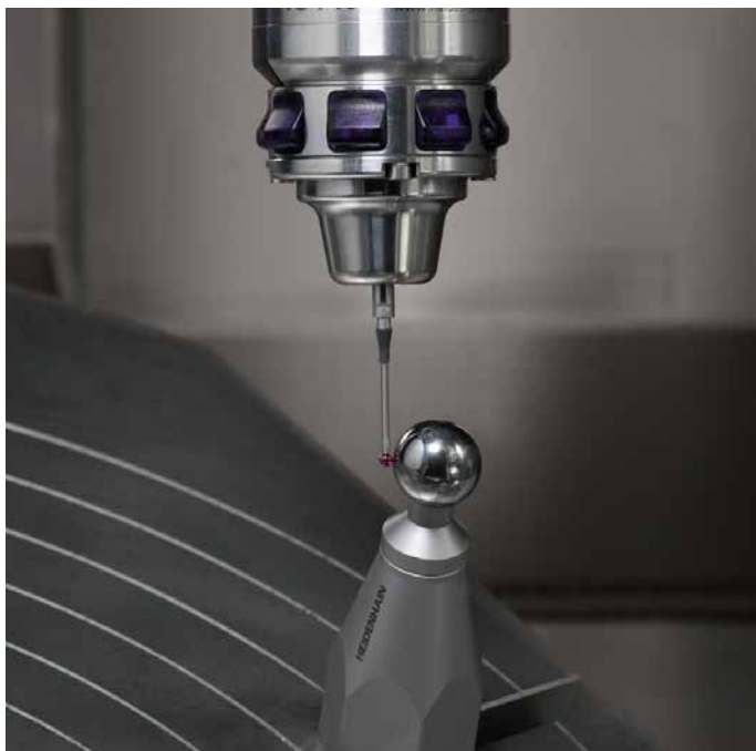
Grazie a KinematicsOpt, il modulo opzionale, si ottiene il controllo e l'ottimizzazione della precisione della macchina attraverso la calibrazione automatica degli assi rotativi.
