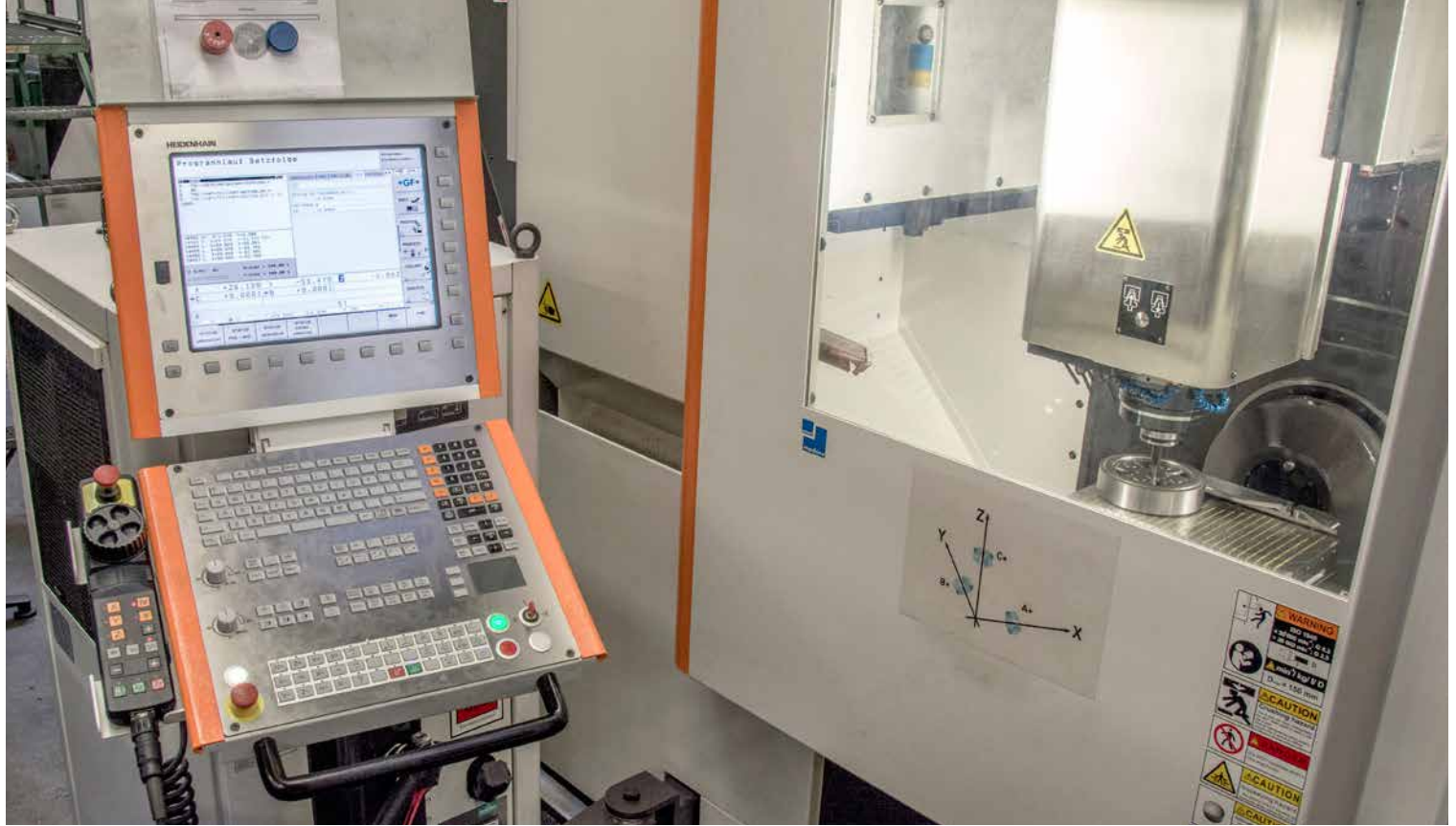
Un team vincente: centri di lavoro Mikron HEM 500U di GF Machining Solutions con controllo numerico TNC.
