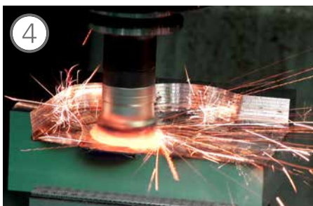
Dopo altri 72 minuti senza AFC: la lavorazione prosegue finché utensile e pezzo diventano incandescenti.
