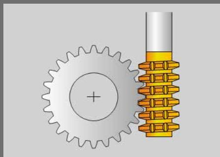
*Il nuovo ciclo 880 rende facilmente programmabile l'operazione di produzione complessa di una ruota dentata con una fresa cilindrica.*
