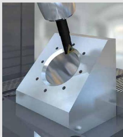
*Con il nuovo ciclo TORNITURA IN INTERPOLAZIONE si eseguono lavorazioni di tornitura in modalità di fresatura senza riserrare il pezzo.*
