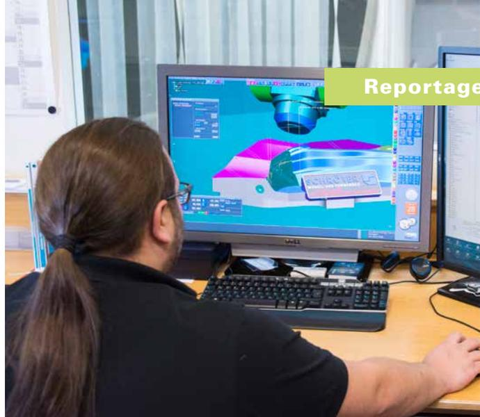
*Un operatore per l'intero processo: Martin Geisler utilizza il sistema CAD/CAM per predisporre il modello per la produzione, genera il programma NC e successivamente opera anche sulla macchina.*
